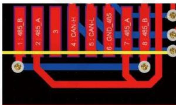
Definizione del pin della porta RJ45 per Meter-485
