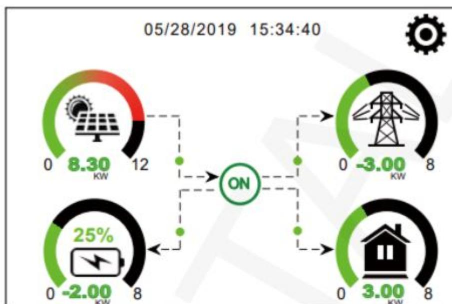
1. Se l'icona centrale nella schermata iniziale è visibile, significa che il sistema è operativo e funziona correttamente. Se, invece, appare la dicitura 'comm./F01~F64', ciò indica problemi di comunicazione o altri errori nell'inverter. I dettagli specifici degli errori, numerati da F01 a F64, verranno mostrati sotto l'icona e sono consultabili nel menu 'Allarmi di sistema'.
