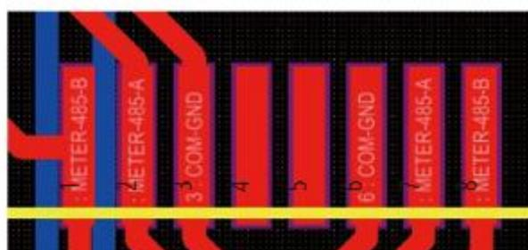
Specifiche dei pin della porta RJ45 per la "porta Modbus" per il monitoraggio remoto.
