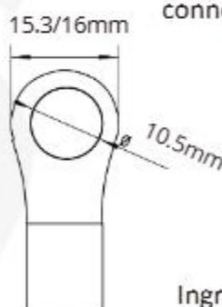
Ingresso DC batteria - Dimensioni cavo 2/1 AWG
