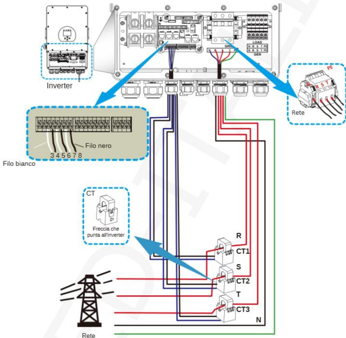
Nota: quando la lettura della potenza del carico sul display LCD non è corretta, invertire la freccia CT.
