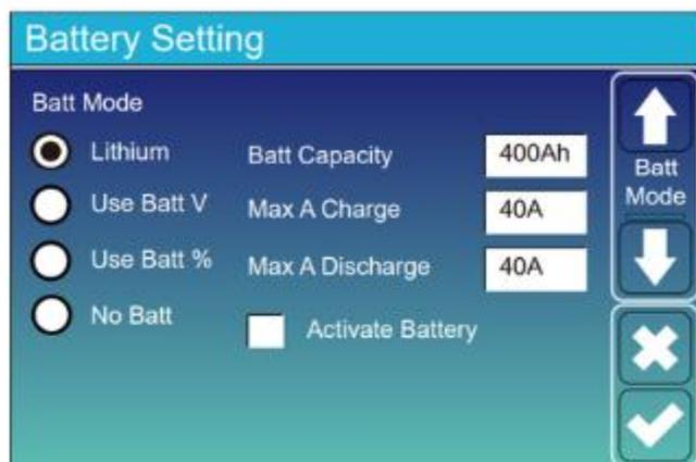
**Batt Capacity:** Informa l'inverter ibrido Deye sulla dimensione del tuo banco di batterie.
