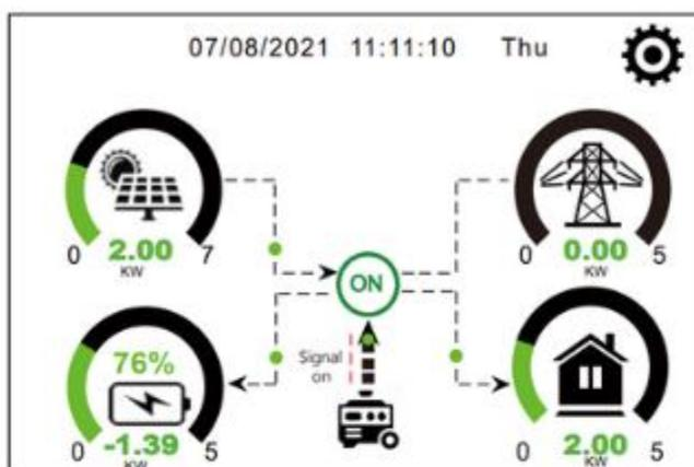
Questa pagina illustra come il generatore fotovoltaico (FV) e il generatore diesel collaborano nell'alimentare sia il carico che la batteria.
