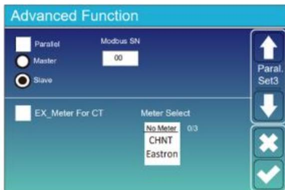
**Ex\_Meter For CT:** Questa funzione è utilizzabile quando l'inverter ibrido è impostato sulla modalità di esportazione zero verso il Sensore di corrente (CT). Selezionando la funzione **Ex\_Meter for CT**, l'inverter può essere configurato per lavorare con diversi tipi di Meter, tra cui modelli di CHNT e Eastron. Questo permette una gestione flessibile e adattabile dell'energia esportata, assicurando che l'inverter non invii energia in eccesso alla rete elettrica.
