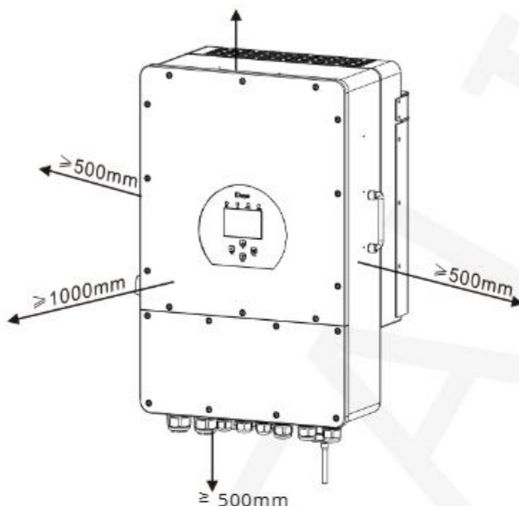
Per garantire una corretta circolazione dell'aria e una efficace dissipazione del calore, è necessario lasciare uno spazio libero di circa 50 cm ai lati e sopra e sotto l'unità, nonché un margine di 100 cm davanti all'inverter.
