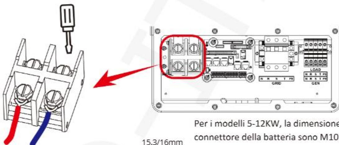
Per i modelli 5-12KW, la dimensione delle viti del connettore della batteria sono M10.
