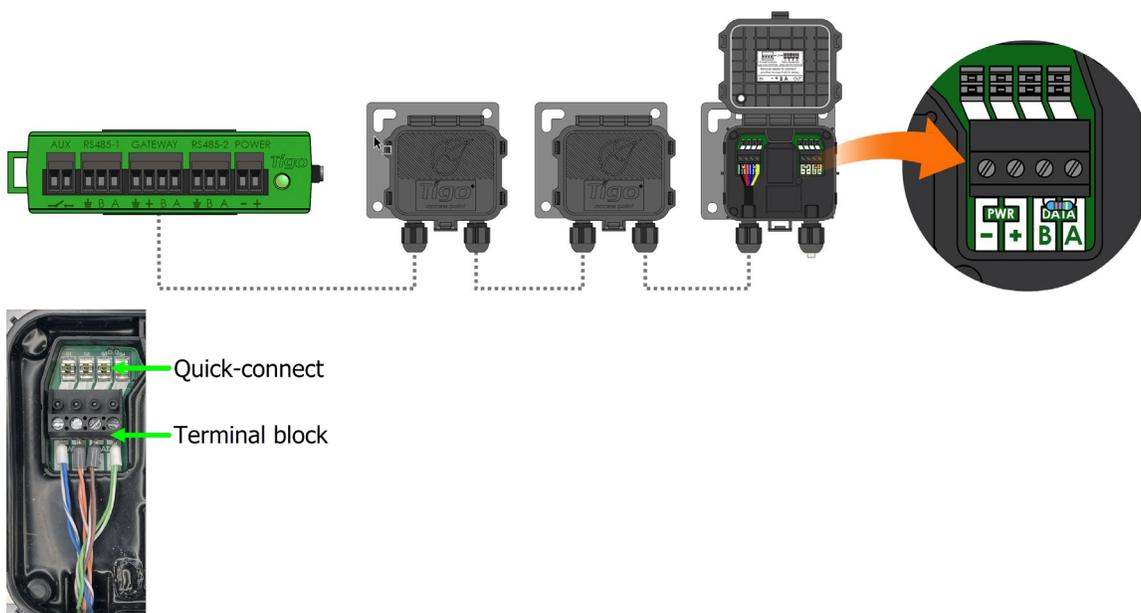
3. Se si esegue il collegamento a un altro TAP, utilizzare i terminali sul lato destro dopo aver rimosso la resistenza di terminazione  $120\Omega$  preinstallata.
