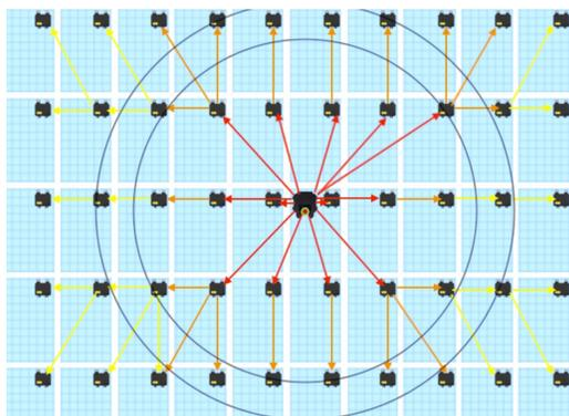
Assicurarsi che non vi siano ostacoli che potrebbero interferire con il segnale TAP con altre unità TS4 nell'array. Se l'array ha più piani del tetto, potrebbe essere necessario installare più TAP. Per i dettagli, fare riferimento all'articolo del Centro di assistenza [Posizionamento e layout del TAP](#).
